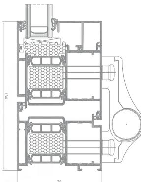
Querschnitt durch eine Tür SP 800 i+
